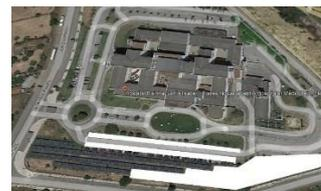
Propõe-se assim a instalação de um sistema fotovoltaico destinado a autoconsumo, apresentando-se deste modo como equipamento de referência 276 Módulos fotovoltaicos s Risen RSM144-6-350P, com azimute 0° (Sul) e inclinação de 35°. Certificado ISO – IEC, perfazendo uma área total de 550 m<sup>2</sup> e uma potência 96.6 kWp (1619kWh/kW instalado).
