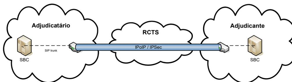
Fig. 2 – Modelo de funcionamento em *SIP trunk*
