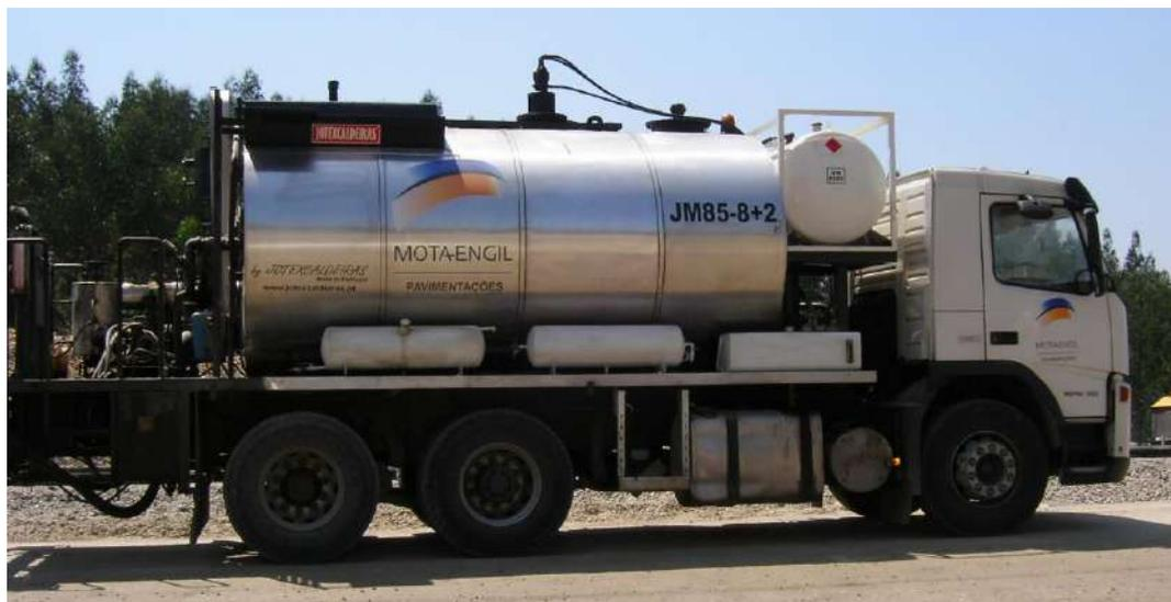
A aplicação da rega de colagem será realizada com recurso a um camião tanque de emulsão. Este tipo de camião possui barra distribuidora de largura ajustável à da faixa a tratar. A taxa de espalhamento é regulável automaticamente por sistema que atua no circuito de bombagem em função da velocidade do camião, garantindo o espalhamento da taxa pré-programada.
